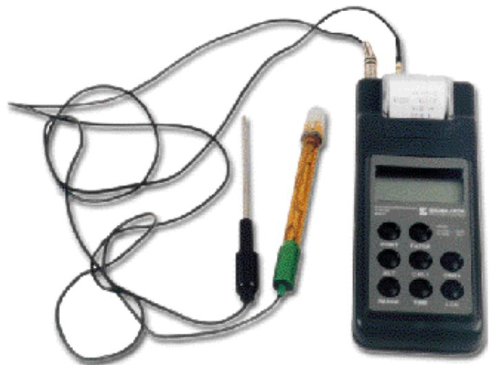
Il suffit donc de planter la sonde du pH-mètre dans le levain liquide ou pâteux et de lire le résultat. Ensuite, on lave la sonde de mesure dans de l'eau (eau du robinet obligatoirement pour ne pas endommager la sonde).
